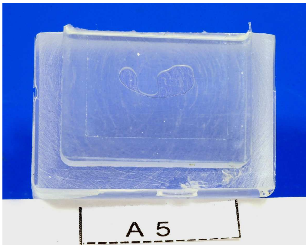
A5, EP37 : photo après 7 cycles - Décollement constaté après 14 cycles. ( premier échantillon décollé )
