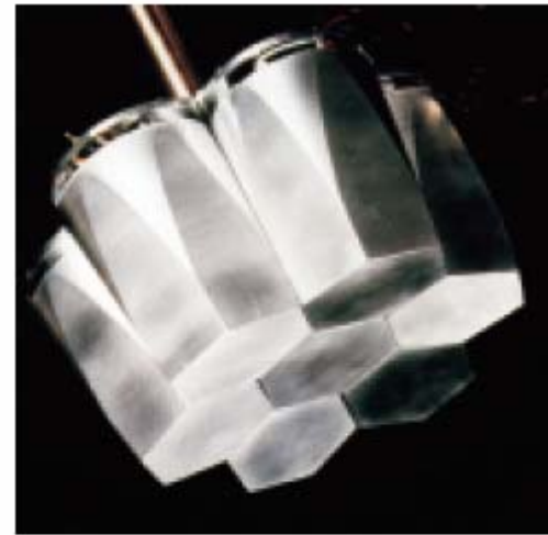
Grappe CLUSTER pour EUROBALL (7 détecteurs GeHP encapsulés)
