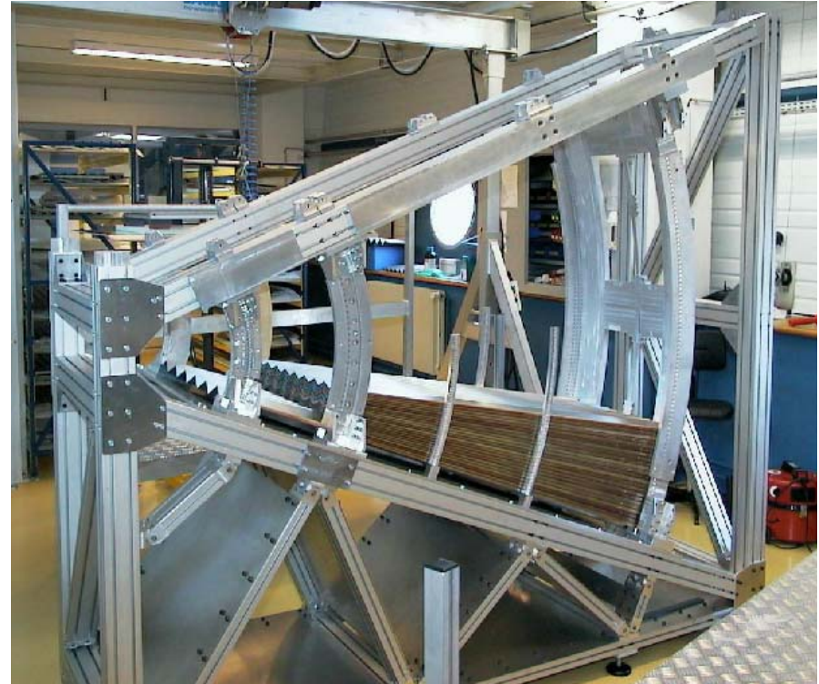
Banc de montage des modules (Photo C. Moirenc)
