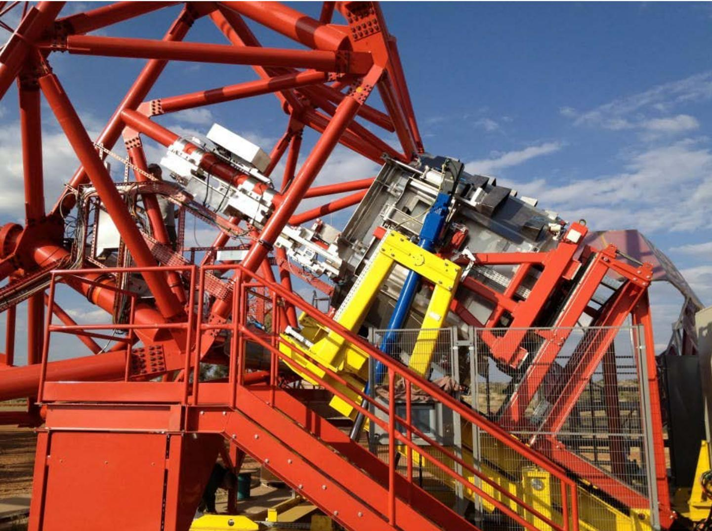
Un robot de 25T va charger et décharger la caméra (2.5T) dans le télescope !
