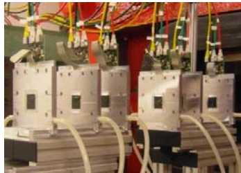
Télescope de faisceau EUDET 6 x Mimosa 26
