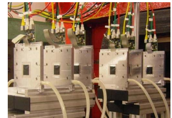
Télescope de faisceau EUDET et son DAQ VME
