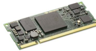
ZX3 Enclustra (CH) 68 x 30 mm Connectique I/O: SODIMM200 257 € (507 € avec carte «Support»)
