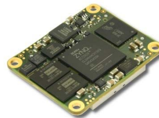
TE0720 Trenz (D) 50 x 40 mm Connectique I/O: 3 x Samtec LSHM 289 € (589 € avec carte «Support»)
