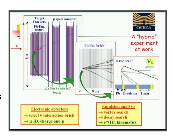
La mise en évidence du tau prouvera l'oscillation (faisceau initial  $v_u$ )
