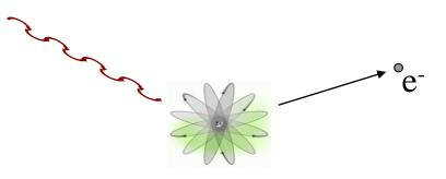
Il s'agit de l'absorption d'un photon d'énergie hv par un atome et de l'éjection d'un électron lie suivant la réaction :
