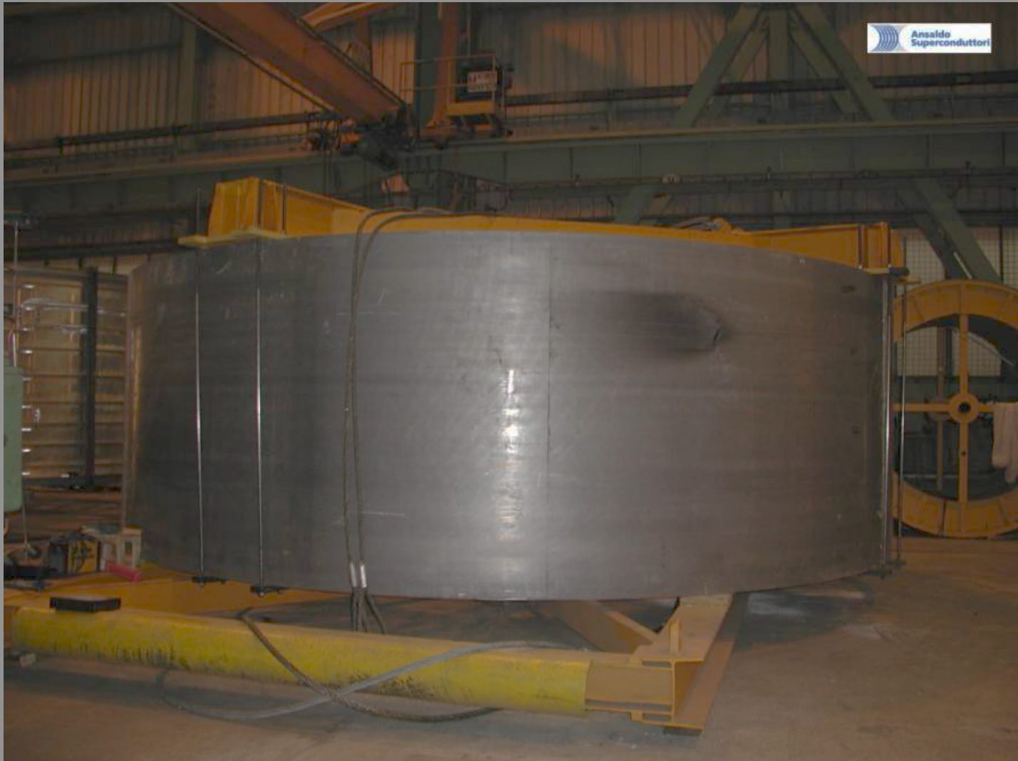
Cylindre extérieur brut en aluminium centrifugé (5083) avant usinage
