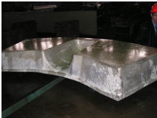
Demi boîte de connexion après forgeage
