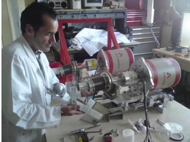
Montage de la mécanique support d'un détecteur Germanium
