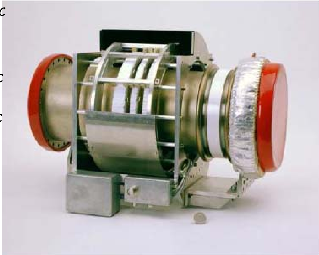
Ensemble de 3 transformateurs (G.S.I.)
