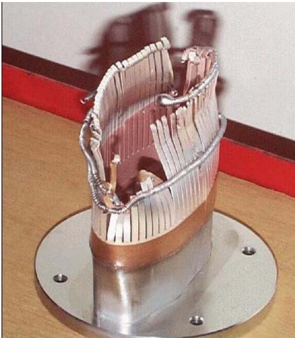
Figure 49 : Photo d'un RF liner ayant subi un échauffement suite à l'absence de contact entre les doigts et la jupe.
