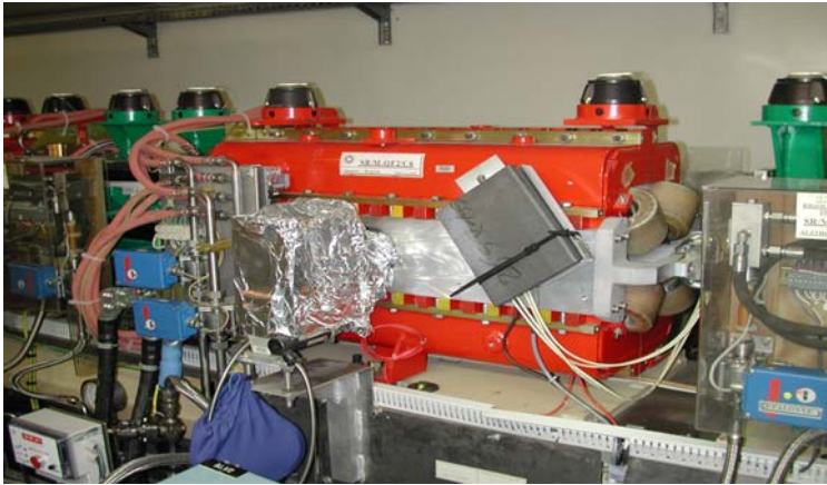
Figure 31 : photo d'un quadrupôle de l'anneau de stockage
