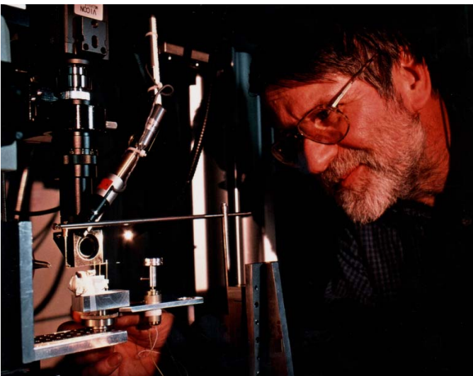
Figure 10 Une araignée est placée dans un dispositif expérimental. Son fil sera exposé aux rayons X afin de déterminer sa structure dès sa production.
