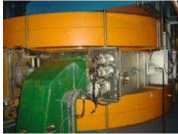
Figure 2: L'électroaimant du synchrocyclotron au centre de protonthérapie d'Orsay
