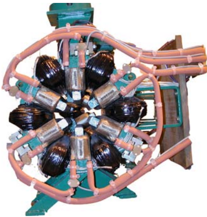
Figure 32 : sextupole de l'anneau de stockage
