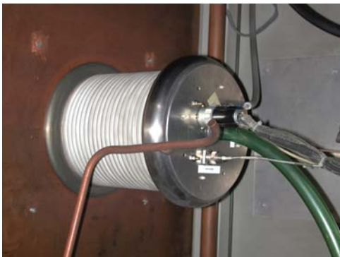
Figure 19 photo du canon à électron et de la cathode du Linac
