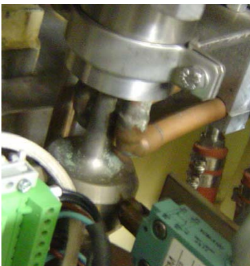
Figure 65 : détails de l'effet de corrosion dans un tuyau coudé.
