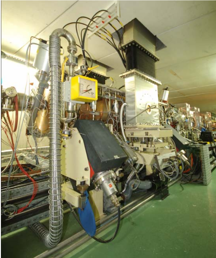
Figure 34 : une des cavités RF de l'anneau de stockage
