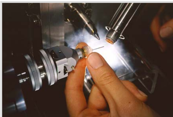
Figure 9 : Un échantillon invisible à l'oeil nu est positionné pour être exposé aux rayons X. Un traitement ultérieur révélera sa structure en 3 dimensions
