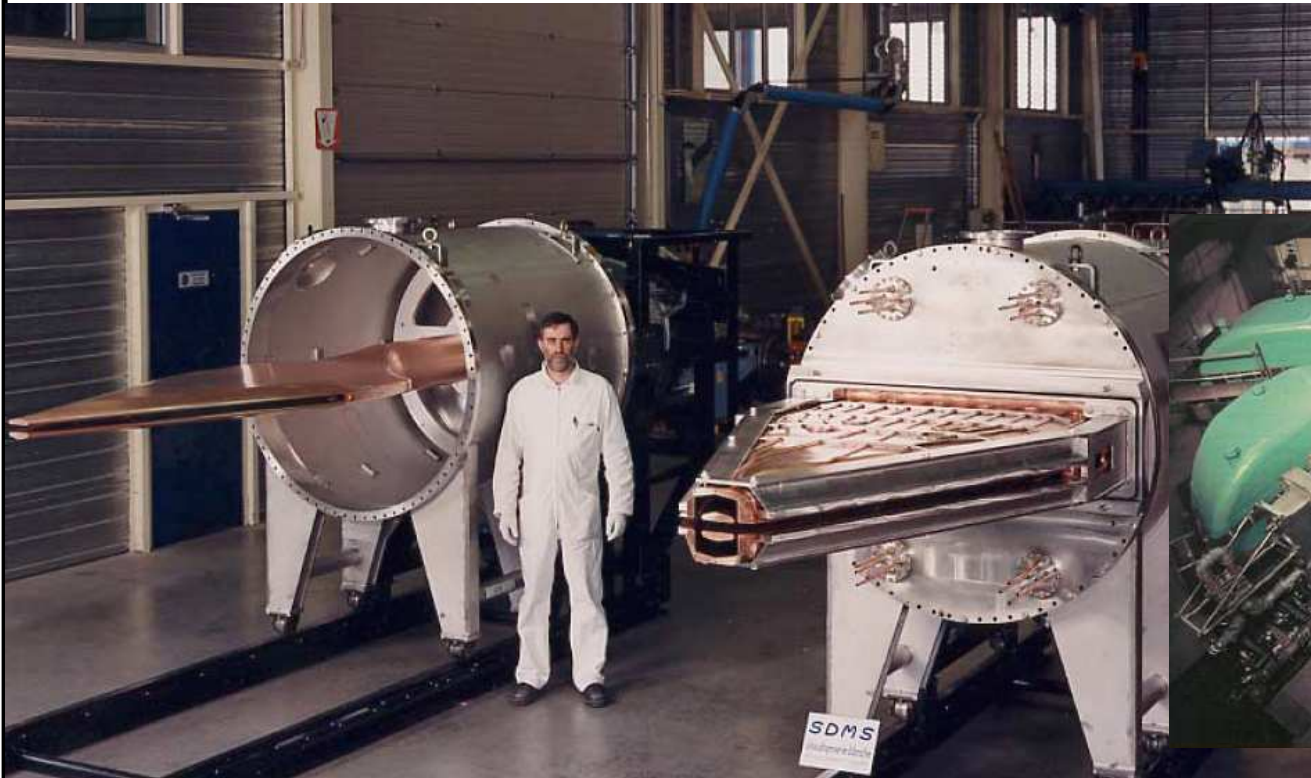
Cavités du cyclotron CIME (GANIL, 9.6 – 14.5 MHz, V_{\max}=100\text{kV} )
