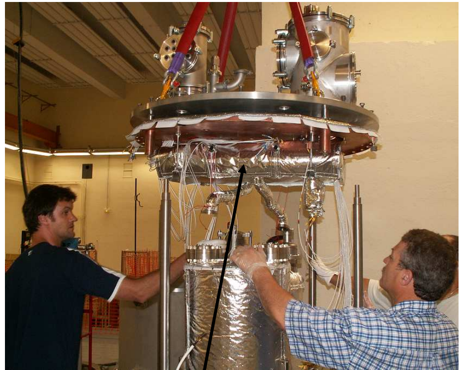
Réservoir tampon He
