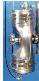
Résonateur demi-onde (Argonne) 355 MHz - \beta = 0,12
