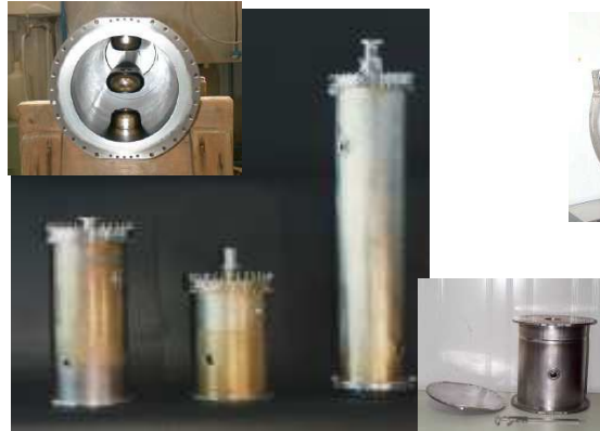
Résonateurs quart d'onde (ALPI, Legnaro) 80 à 352 MHz - \beta = 0,047 à 0,25
