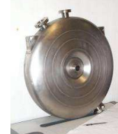
Cavité ré-entrante (Legnaro) 352 MHz - \beta \geq 0,1
