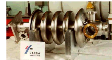
Cavité APT (Los Alamos) 700 MHz - \beta = 0,64
