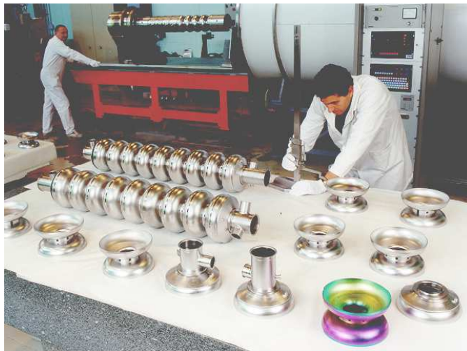
Cavités TTF en cours de soudure chez CERCA (Romans sur Isère, France)
