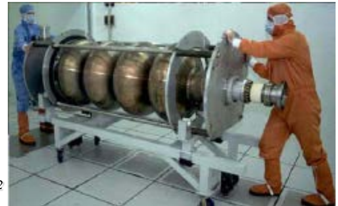
Cavité Nb/Cu 4 cellules – 352 MHz – 1,7 m (CERN → LEP)
