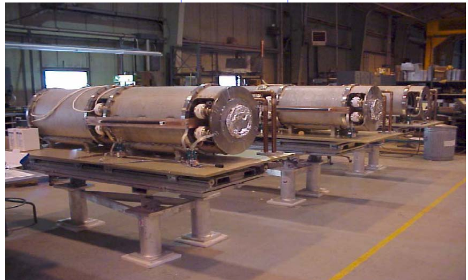
Cavité accélératrice à ferrite du RCS de SNS, 1.23 – 1.67 MHz
