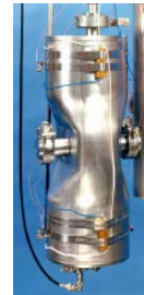
Résonateur demi-onde (Argonne) 355 MHz - \beta = 0,12
