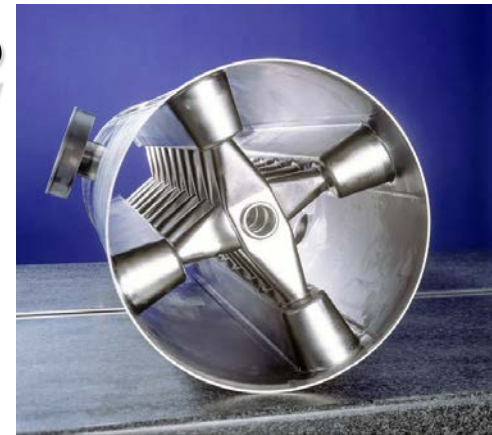
19-gap CH-DTL (Frankfurt)) 350 MHz - \beta \sim 0,1
