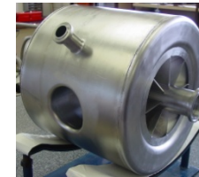
Cavités spoke (CNRS Orsay) 352 MHz - \beta = 0,15 et 0,35
