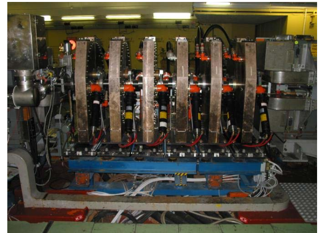
6 cavités 200 MHz au PS (CERN) -> mise en forme longitudinale avant extraction
