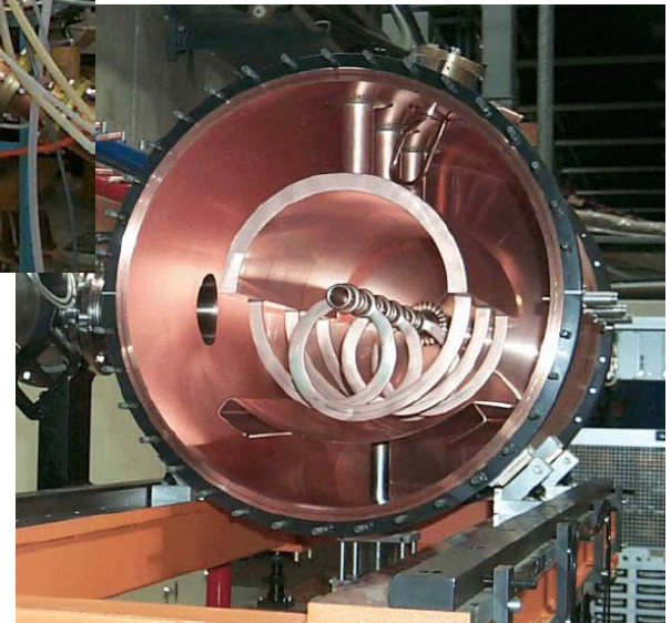
Résonateur 7-gap (Rex-Isolde), 101.3 MHz
