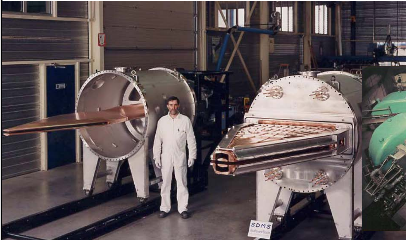
Cavités du cyclotron CIME (GANIL, 9.6 – 14.5 MHz, V_{\max}=100\text{kV} )
