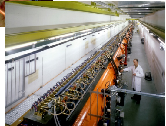
DTL Linac 2, (CERN, 1978) : 202 MHz, p 50 MeV
