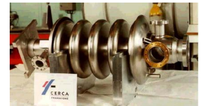
Cavité APT (Los Alamos) 700 MHz - \beta = 0,64
