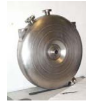
Cavité ré-entrante (Legnaro) 352 MHz - \beta \geq 0,1
