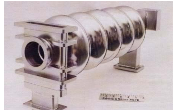
Cavité Nb 5 cellules – 1,5 GHz – 0,5m (Cornell → CEBAF)
