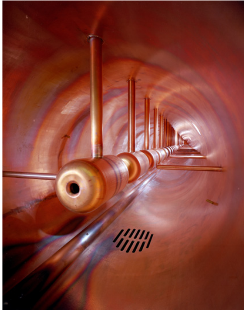
Fermilab DTL : -> 116 MeV, 425 MHz
