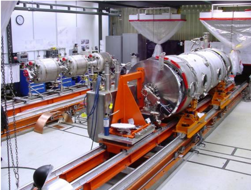
Exemple d'assemblage de cryomodule (SNS)
