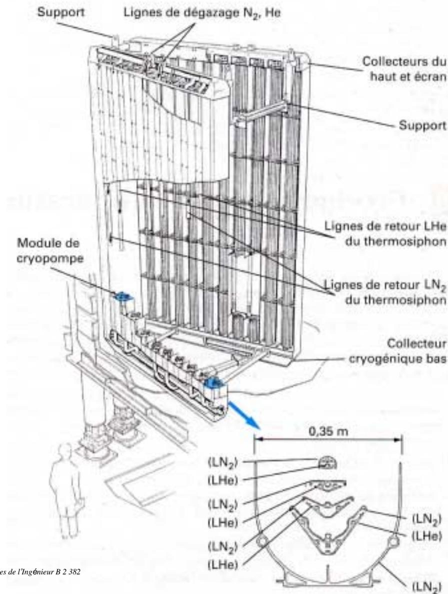
Cryopompe à grand débit en continu sur le réacteur de fusion thermonucléaire JET (GB).
