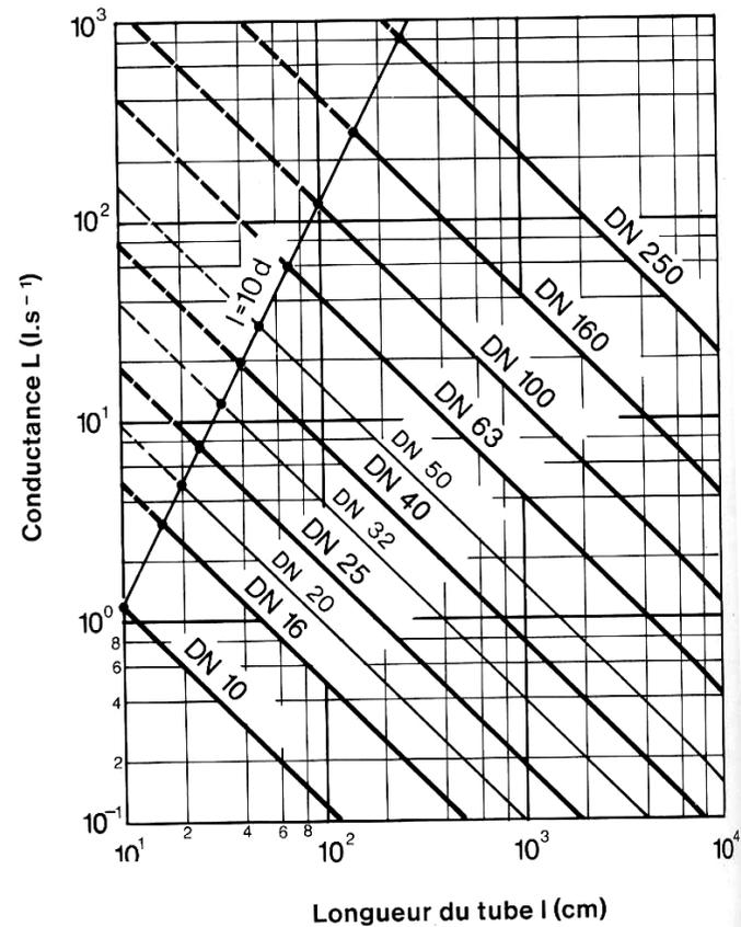
Écoulement moléculaire air à 20°C
