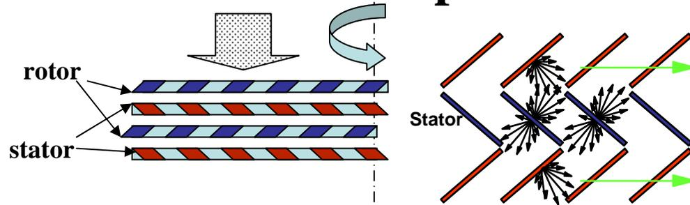
Entraînement des molécules de gaz par choc avec les pales à haute vitesse
