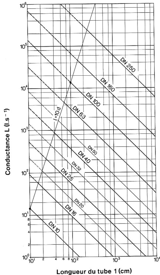
Écoulement laminaire air à 20°C
