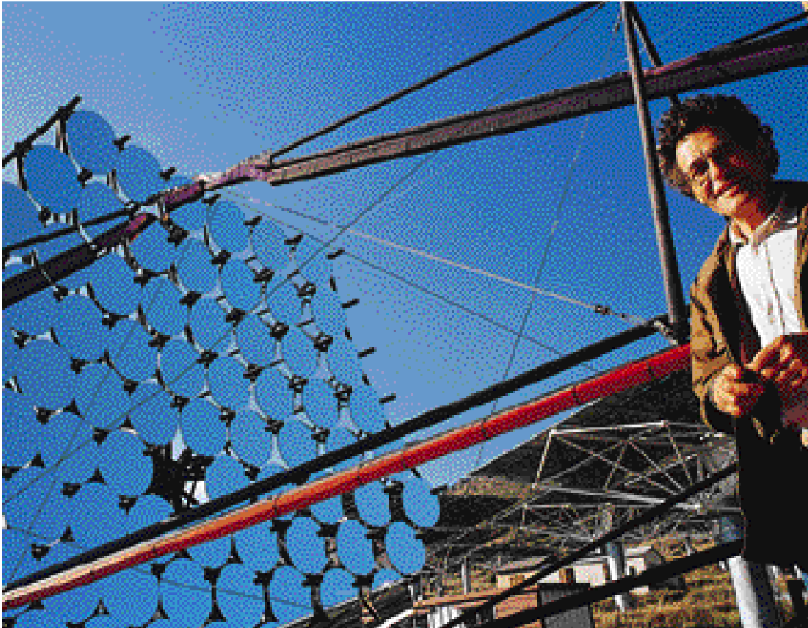
Le télescope CAT : observation des gamma cosmiques de 200 GeV. Vue du miroir depuis la plate-forme d'accès à la caméra dans le hangar. © CNRS/L.Médard.
