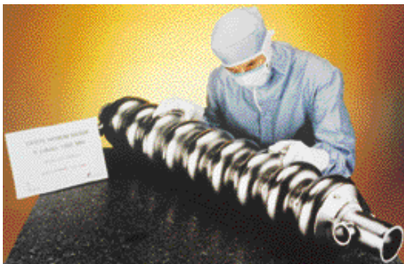
Cavité supraconductrice 9 cellules 1,3 GHz. Crédit: IN2P3.
