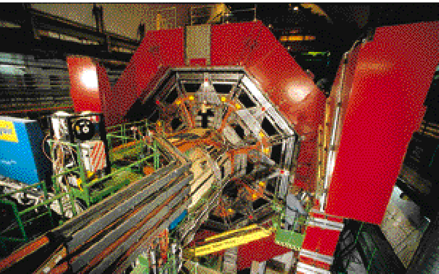
Vue générale du spectromètre à muons dans le détecteur L3, avec les portes de l'aimant ouvertes. © Cern.
