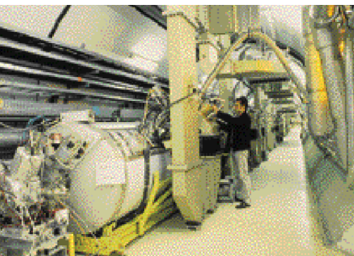
Cavités supraconductrices pour LEP-2 au Cern. © Cern.
