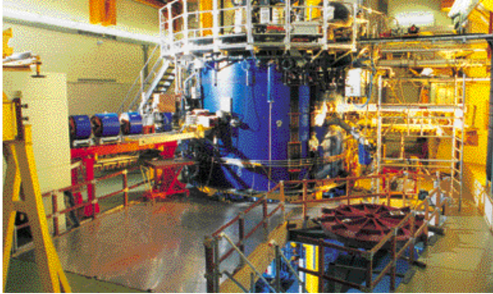
Le cyclotron, supraconducteur Agor à Groningue. © Picture Report.
