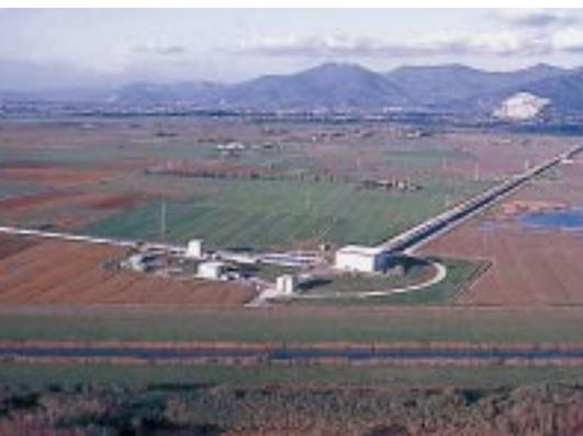
Vue aérienne du site Virgo à Cascina en janvier 2001 : le bâtiment central, le tunnel de 144 m abritant le mode-cleaner (qui permet d'éliminer les imperfections du faisceau laser), et les deux bras perpendiculaires de 3 km de long (le bras nord est entièrement fini alors que la construction du bras ouest est en cours avec les premiers éléments de couverture).
