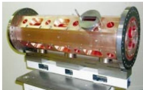
Préprototype d'une section du quadripôle radiofréquence.
