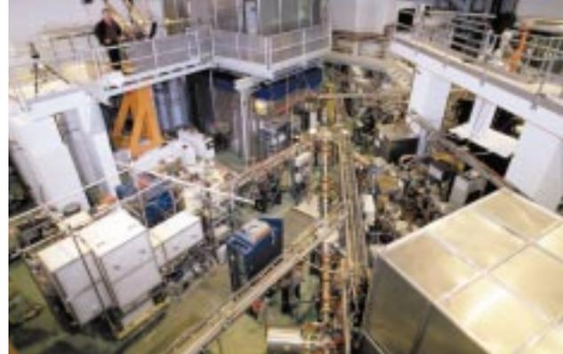
Vue générale du hall d'Isolde. Le séparateur d'isotope en ligne est dédié à la production d'une grande variété de faisceaux d'ions radioactifs pour de nombreuses expériences.
