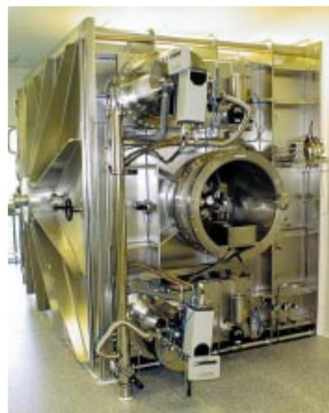
Le bâti de dépôt IBS est un parallélépipède de 2,4 x 2,4 x 2,2 m.
