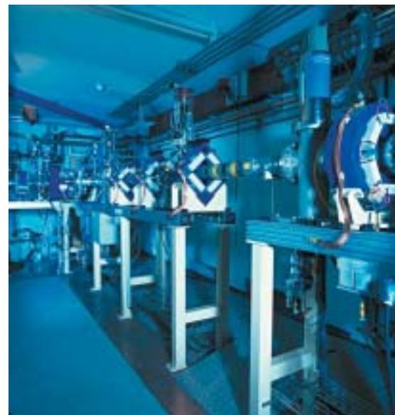
Ligne permettant de diriger le faisceau des noyaux exotiques produits par Spiral vers les salles d'expérience.
