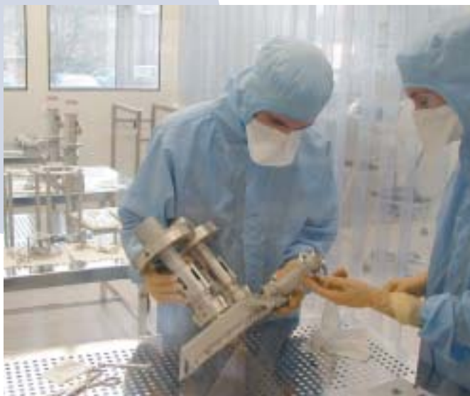
Coupleurs de puissance en cours de montage en salle blanche classe 10. © CNRS/IN2P3
