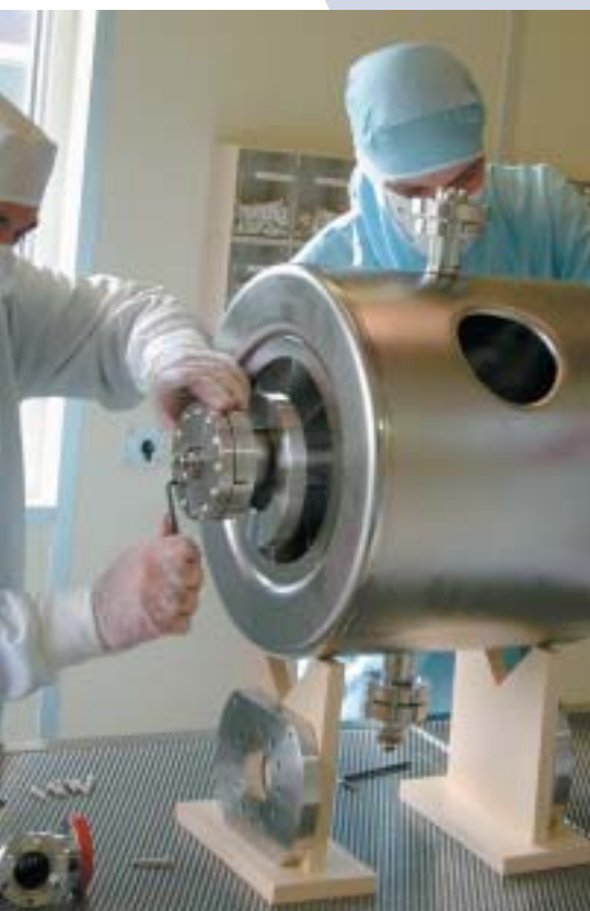
Préparation et montage en salle blanche de la cavité supraconductrice «spoke» avant le test en cryostat vertical à 4 K. © CNRS-IN2P3
