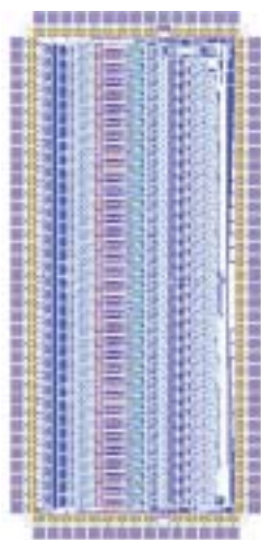
« Layout » de l'Asic de lecture des photomultiplicateurs 64-anodes de l'expérience Opera au Gran Sasso. © CNRS/IN2P3
