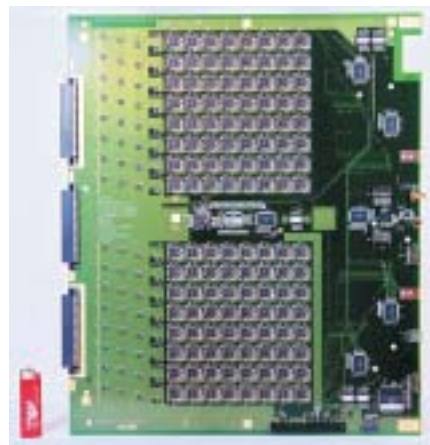
Carte calibration pour l'expérience Atlas: 128 Asics générateurs d'impulsions 100 \mu V-5V
