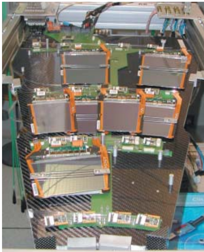
Secteur d'un bouchon du trajectographe de CMS partiellement équipé. © CNRS/IN2P3
