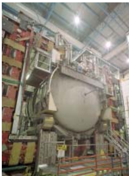
Grand calorimètre à argon liquide du détecteur D0. © Collaboration D0
