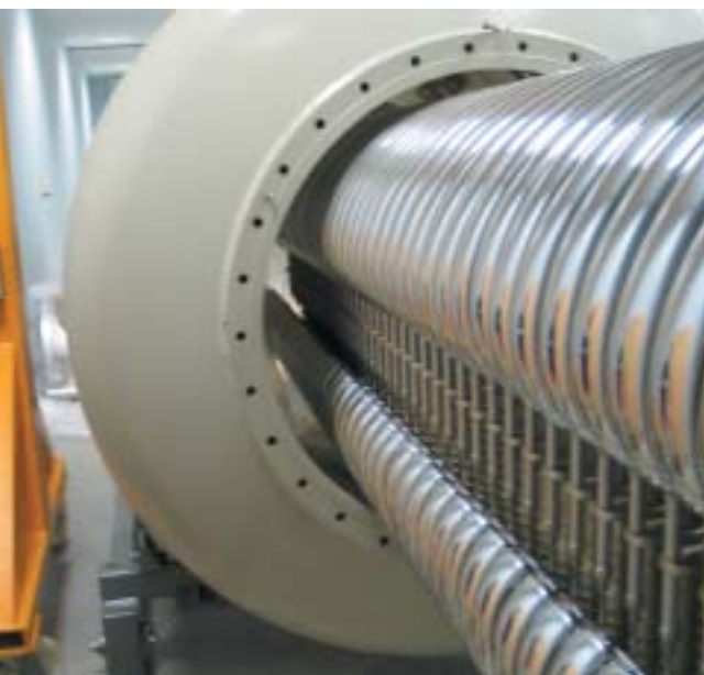
Partie accélératrice de l'accélérateur Aifira. © CNRS/IN2P3
