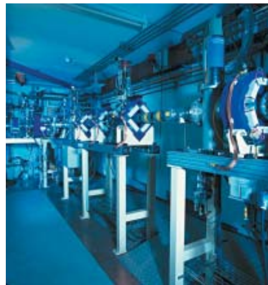
Ligne permettant de diriger le faisceau des noyaux exotiques produits par Spiral vers les salles d'expérience. © Ganil, M. Désaunay
