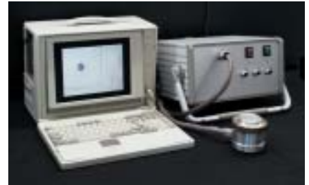
L'imageur Poci (Peroperative Compact Imager). © CNRS/IN2P3
