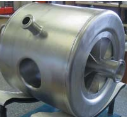
Cavité spoke. © CNRS/IN2P3
