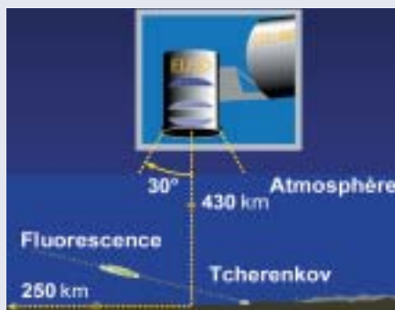
Le télescope spatial d'Euso dédié à la détection des rayons cosmiques d'énergie extrême scrutant l'atmosphère terrestre à partir de la Station spatiale internationale. © CNRS/IN2P3
