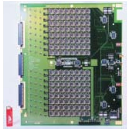
Carte calibration pour l'expérience Atlas: 128 Asics générateurs d'impulsions 100 \mu V-5V
