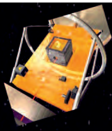
Un éclaté d'un des bancs optiques d'un satellite de Lisa. On voit la masse témoin (cube doré) et les chemins suivis par les faisceaux lasers pour l'interférométrie. © Albert Einstein Institute (Hanovre/Postdam)
