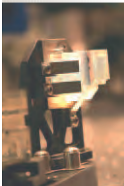
le « slicer » ou découpeur d'image du spectrographe sur son support réalisé au CPPM.
