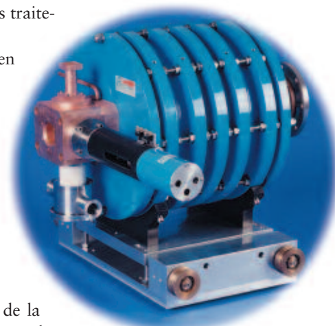
SuperNanogan, la plus grande source d'ions à haut état de charge ECR (résonance électronique cyclotronique). © Pantechnik.
