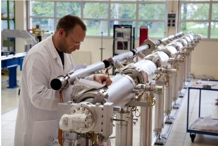
Montage du système de distribution d'hélium cryogénique sur un train de cavités de XFEL © Dumas/CEA
