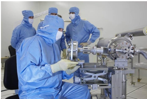
Assemblage des cavités accélératrices en salle blanche. © Dumas/CEA
