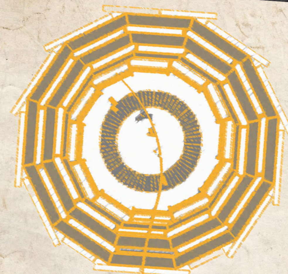
Trace de muon cosmique dans le détecteur CMS © CERN
