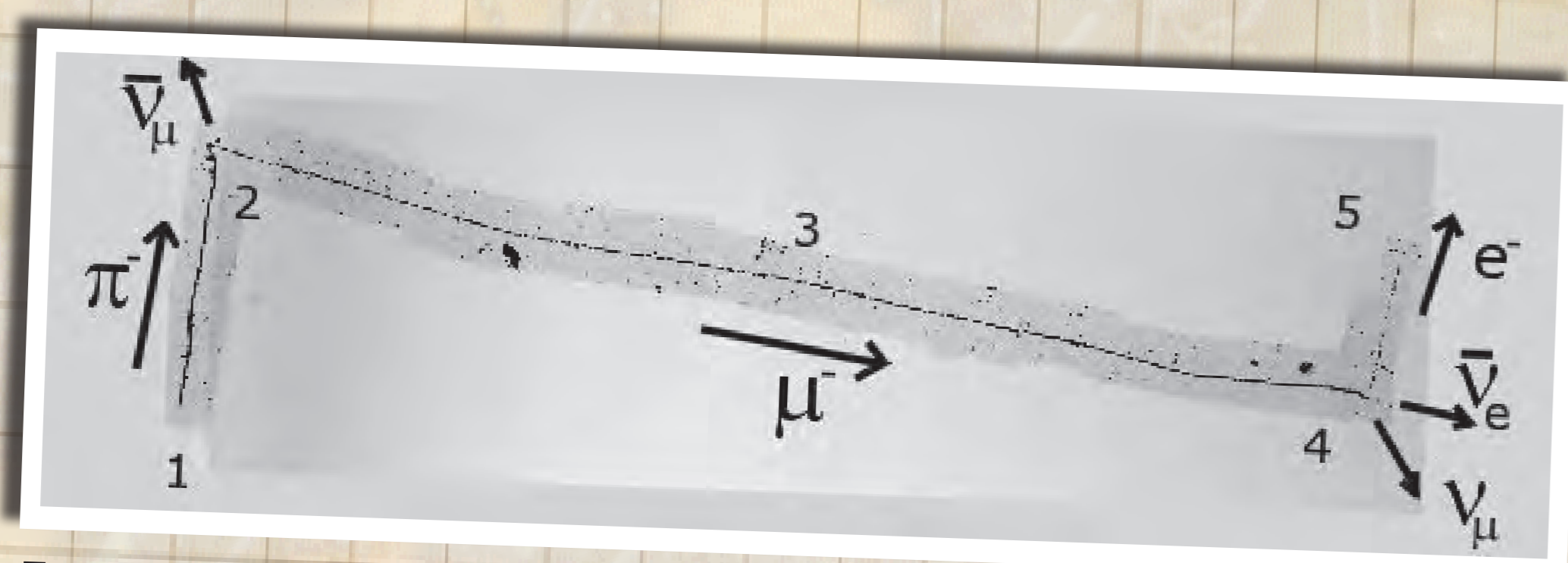
Emulsion montrant une chaîne de désintégration mettant en jeu le pion et le muon © DR
